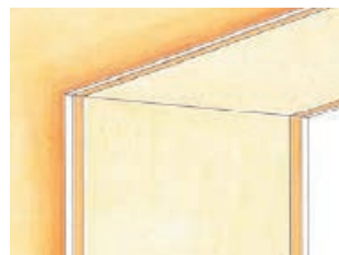
Przyklejanie elementu ściany bocznej za pomocą Körapur 572
