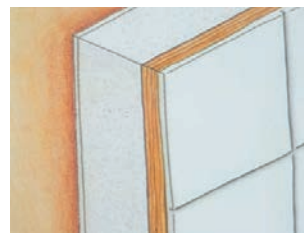
Sklejanie czterowarstwowego elementu typu „sandwich”
