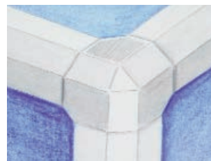
Przyklejanie profilu oprawiającego za pomocą Körapop 225 / 2-składnikowego
