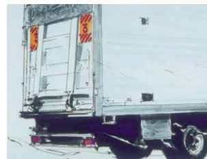
Szpachlowanie platformy hydraulicznej za pomocą Körapox BS 90
