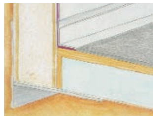
Przyklejanie listwy przypodłogowej za pomocą Körapur 840
