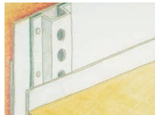
Uszczelnianie nitowanych profili za pomocą Ködiplast CS
