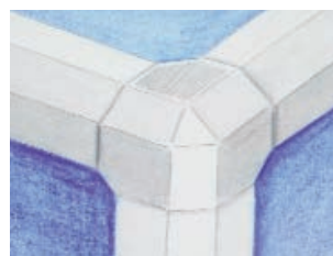
Przyklejanie profilu oprawiającego za pomocą Körapur 140 / 2-składnikowego
